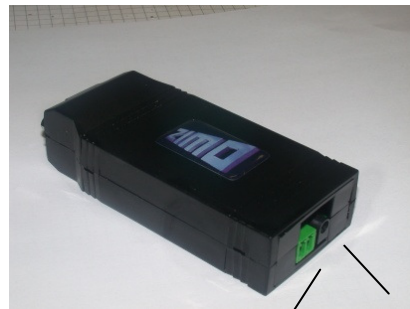
Anschluss Update-Gleis Betriebskontroll-LED's für Netzgerät hinter der Buchse
